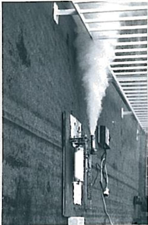
Diese Serie zeigt die unterschiedlichen Rauchintensitäten im Verlauf des Schubtestes. Das erste Bild zeigt die Rakete zur Zeit des stärksten Schubes. Das zweite Bild zeigt die Schubabnahme bei der 2. Phase. Beim 3. Bild liegt Brennschluß vor.
